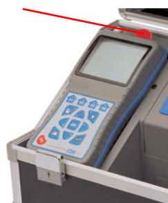
Prijenos podataka između kontrolne i osnovne jedinice se izvodi preko radio prijenosa (868 MHz) sa dometom od 50 m. Kvaliteta radio prijenosa je vidljiva u glavnom meniju (duga crta = dobra radio komunikacija).
